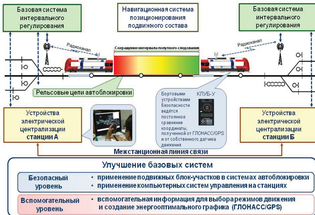
Рис. 1. Система интервального регулирования движения поездов без проходных светофоров
