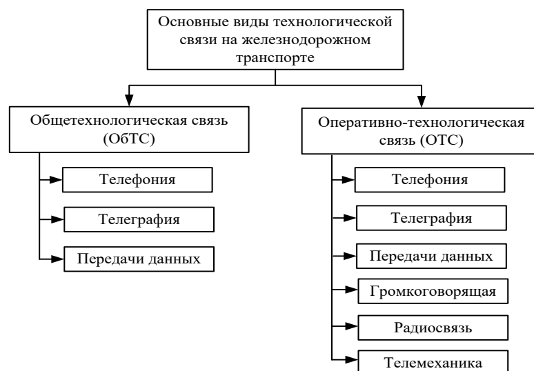
Рис.4. Классификации основных видов технологической связи на железнодорожном транспорте
