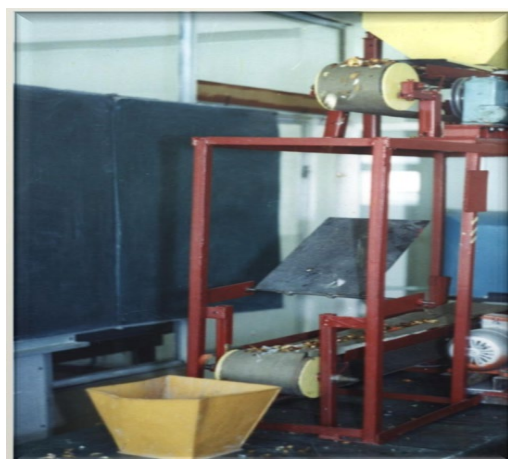
Рис.1. Общий вид устройства для сортировки пищевых отходов.
