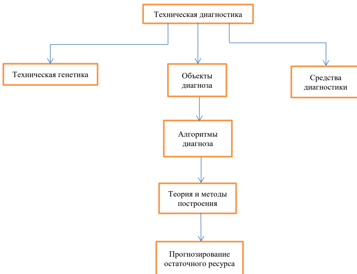
Рис 1. Логическая связь технической диагностики с прогнозированием остаточного ресурса эксплуатируемых сооружений
