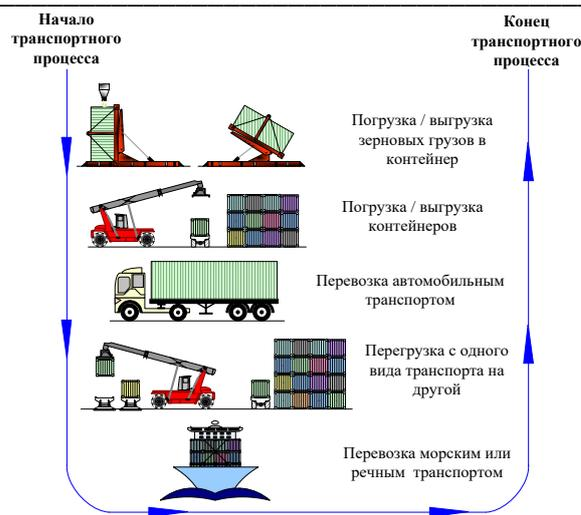
Рис. 6 – Схема интермодальной перевозки насыпных грузов в контейнерах, насыпью (автомобильным и водным транспортом)
