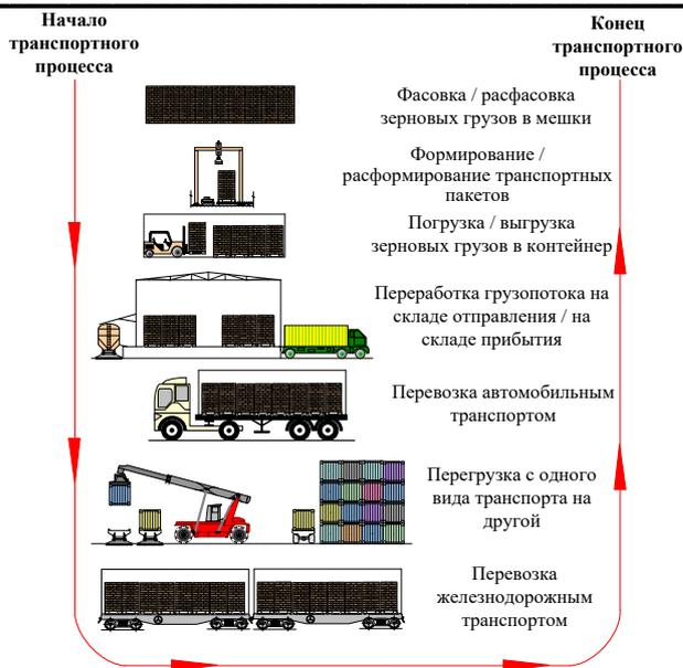
Рис. 2 – Схема интермодальной перевозки насыпных грузов в транспортных пакетах
