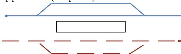
Рис. 6. Однопарный погрузочно-разгрузочный фронт с выставочными путями
