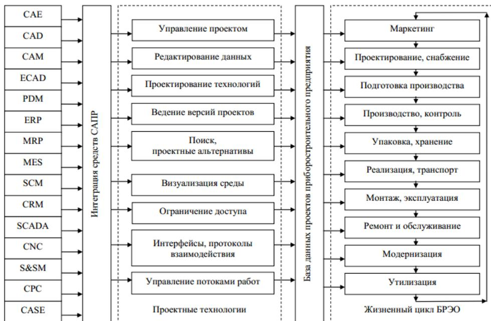
Рис. 1. Функциональная схема взаимодействия гетерогенных инструментов САПР в рамках единой отраслевой САПР поддержки жизненного цикла OEM
