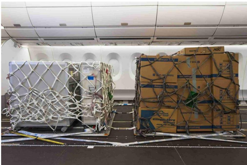
Рис. 5. Испытание груза в салоне Airbus A350
