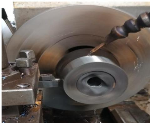
Рис.8. Обточка вала  $\varnothing 100$  мм из стали марки 5ХНМ
