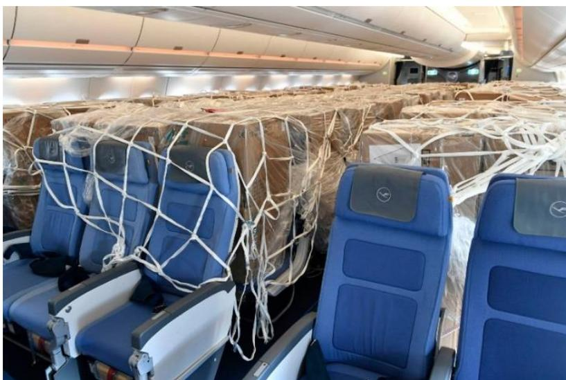
Рис. 2. Размещение груза в салоне грузового отсека пассажирских самолетов.
