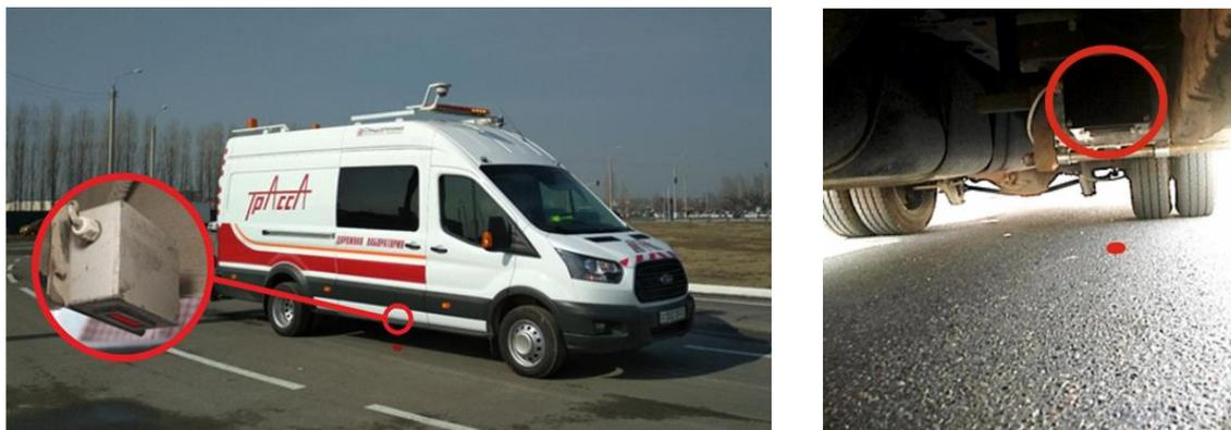
Рис. 1. Система измерения ровности покрытия дорог IRI и работа лазерного профилометра ПКР-2 на ПДЛ «Трасса»
