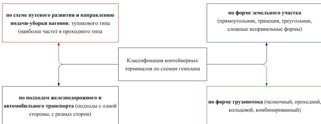
Рис. 5. Классификация контейнерных терминалов по схемам генплана
