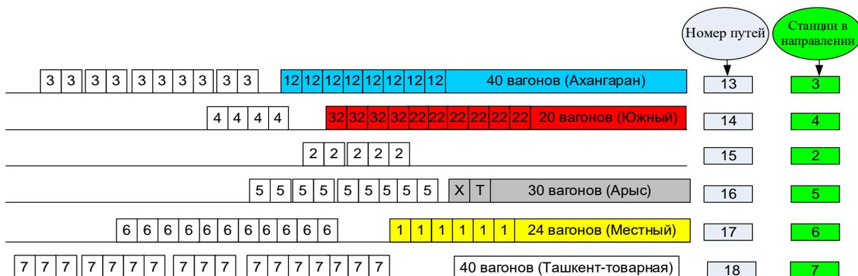
Рис. 5. Процесс сортировка состава с сортировочной горки в порядке по расположению их в направлении.
