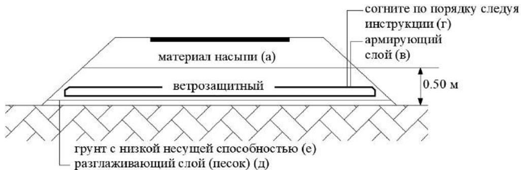
Рис. 5. Армированный слой под насыпью
