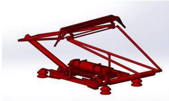
Рис. 5. Трехмерная модель токоприемника ТЛ-13У, созданная в SolidWorks
