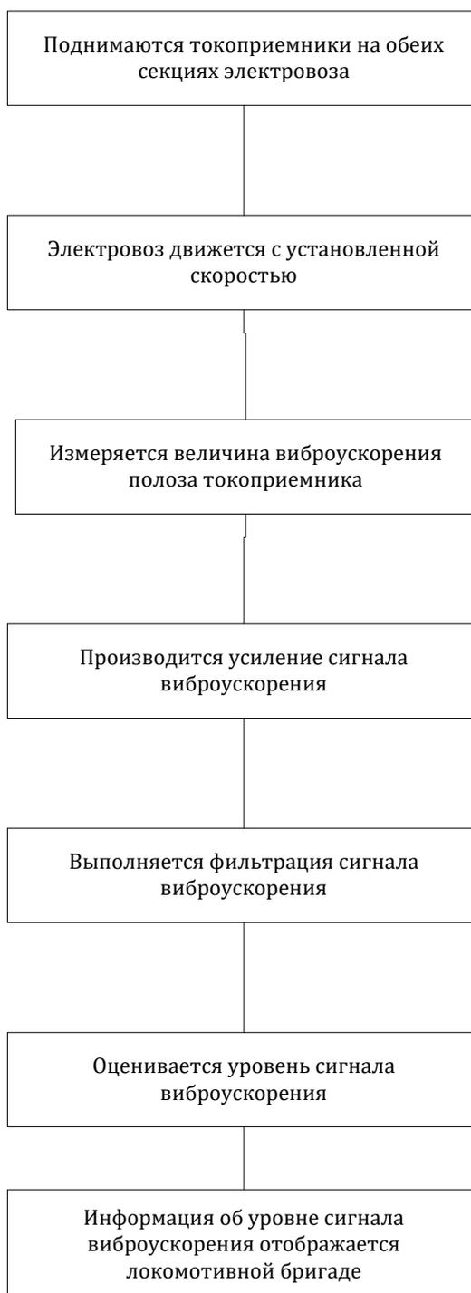
Рис. 8. Порядок способа определения состояния ТВ
