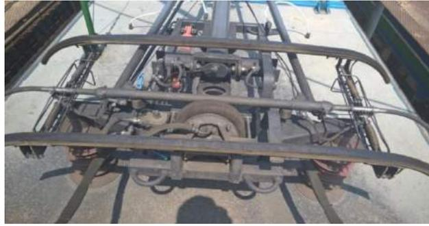
Рис. 5. Аэродинамическое диагностическое устройство токоприемника
