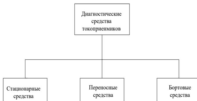
Рис. 2. Типы диагностических средств токоприемников
